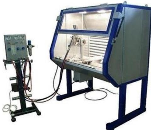
Рисунок 1 – Оборудование для газопламенного напыления типа ППМ-10
