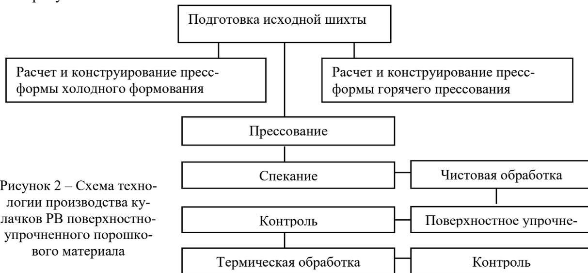
Рисунок 2 – Схема технологии производства кулачков РВ поверхностно-упрочненного порошкового материала
