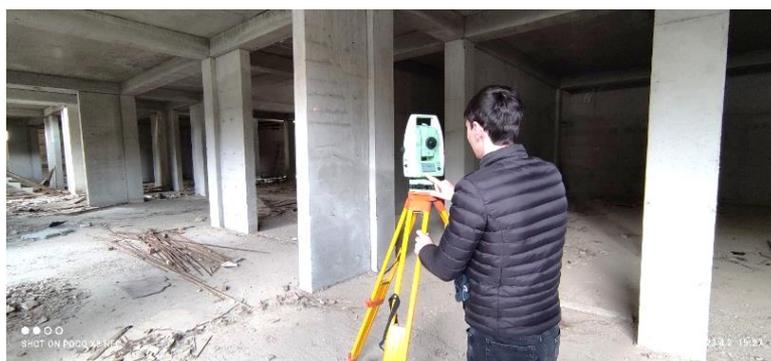
Рисунок – Базовая плоскость тахеометра и процесс обмера
