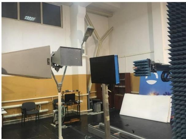
Рисунок 1 – Установка испытания на радиопоглощение
