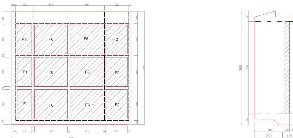
Рисунок 1 – Схема расположения теплоизоляционного слоя в внешней сплошной трехслойной стеновой панели без оконного проема
