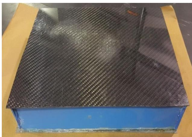
Рисунок 2 – Трёхслойная конструкция из углепластика
