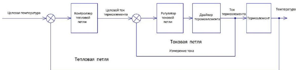
Рисунок – Структура системы управления
